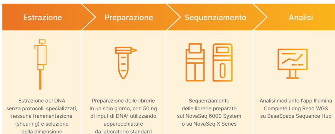
Figura 1: flusso di lavoro di Illumina Complete Long Read Prep, Human. Illumina Complete Long Read Prep, Human offre un flusso di lavoro ottimizzato costituito da quattro fasi, ovvero, estrazione del DNA, preparazione delle librerie, sequenziamento e analisi dei dati.
