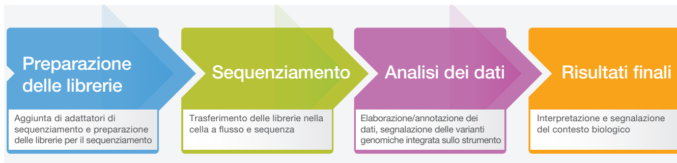
Figura 2: Flusso di lavoro del MiSeq System: il flusso di lavoro ottimizzato del MiSeq System assicura tempi di elaborazione rapidi per il sequenziamento da banco di nuova generazione. Le librerie possono essere preparate con qualsiasi kit di preparazione delle librerie compatibile. Il sequenziamento dura cinque ore e mezza e include: generazione di cluster, sequenziamento e identificazione delle basi qualitativamente valutate con scansione a doppia superficie per una corsa di 2 × 25 coppie di basi su un MiSeq System con il MiSeq Control Software.
